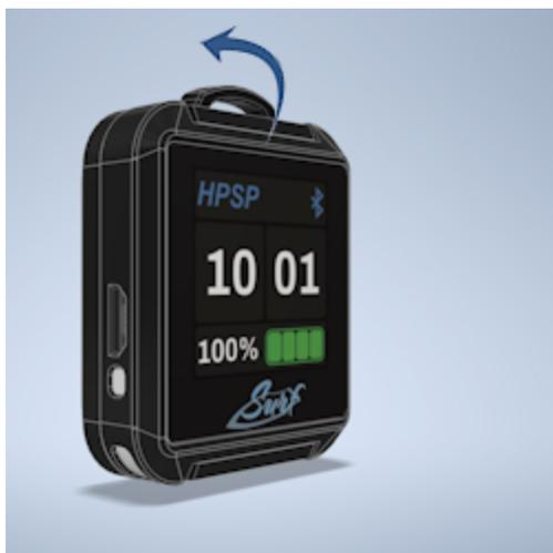
Потяните пальцем за один из выступов по краям от экрана устройства и освободите один край. Далее извлеките аксессуар из пазов в устройстве. Не прилагайте чрезмерные усилия при их снятии, это повредит крепление, аксессуар или само устройство. Не используйте отвертки, ножи и прочие инструменты для снятия аксессуаров.
