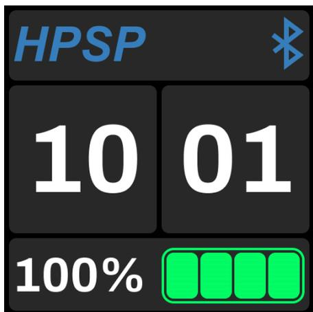
Для включения устройства нажмите кнопку на правой грани устройства и дождитесь включения зеленого светодиода. Когда включится экран зеленый светодиод погаснет а на экране вы увидите логотип “HPSP”. После чего логотип исчезнет и изображение сменится на главный экран устройства.
